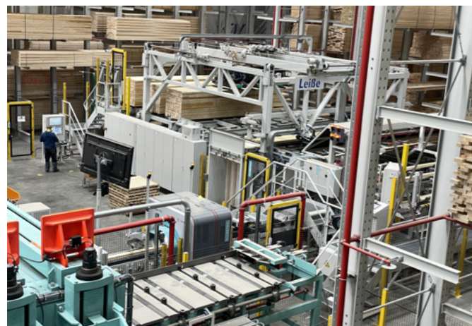
Nach der Vakuumstapelung von Leisse gelangt die Rohware zur Microtec-Qualitätsbeurteilung
